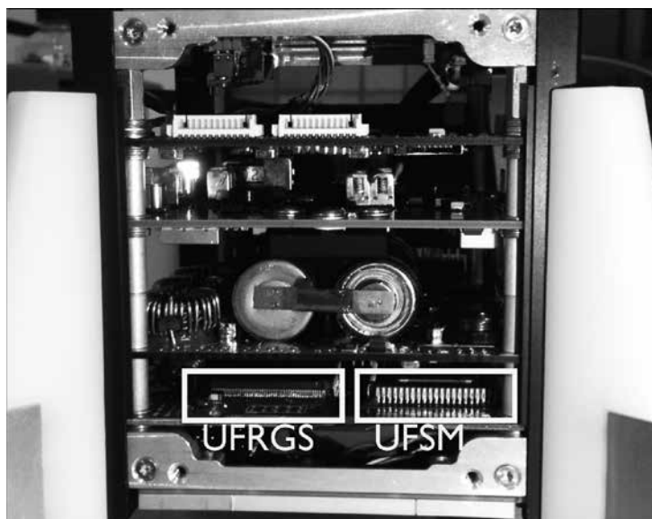
Figura 2. NanoSat-BR1 incluindo chips desenvolvidos pela UFRGS e UFMS
