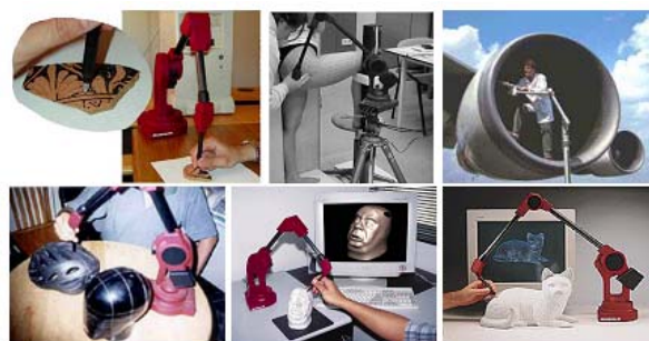
Figura 3: Exemplos de digitalização 3D com braço articulado.
