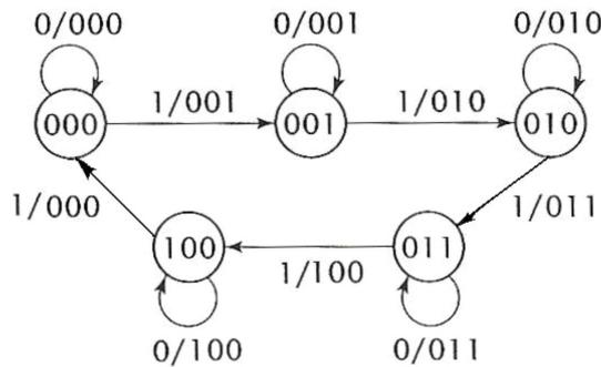
Seja a máquina de estados finitos representada pelo diagrama acima, determine o modelo (Mealy ou Moore) e o circuito digital ao qual ela corresponde.
